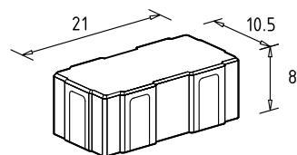
*Pavés Perfora 21x10,5x8 livrés en paquet, appareillage chevrons, pour pose mécanique.*
